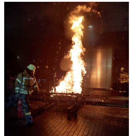
Bild 4. Bis zu 800 °C muss das Material bei dem Brandtest widerstehen. Dadurch wird sichergestellt, dass die Batterie kein Feuer fängt (© Warringtonfire)
